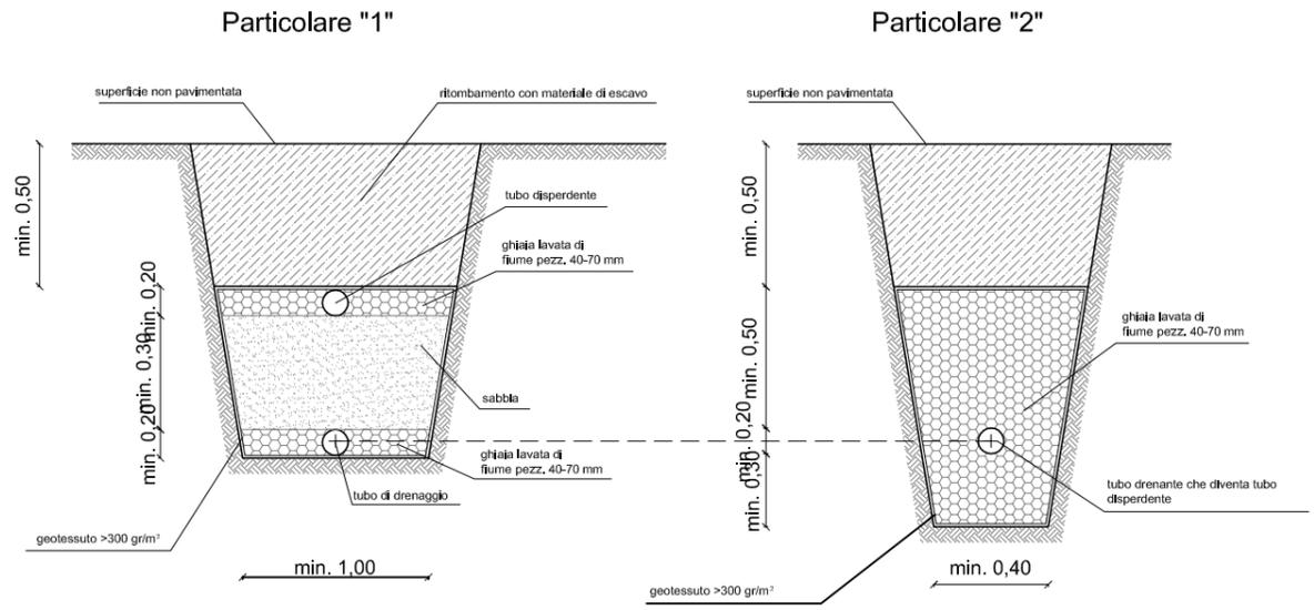
SEZIONE TRINCEA E SUB-IRRIGAZIONE SENZA FILTRO A SABBIA
