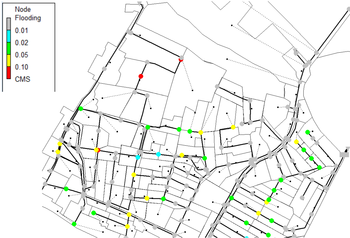
Mappatura allagamenti schematizzata come flooding dai nodi (piezometrica maggiore del piano stradale), T_r 20 anni a seguito interventi stralcio 1
