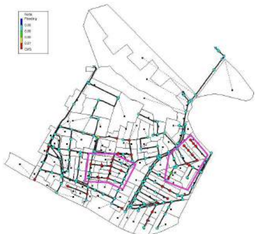
Rappresentazione planimetrica del flooding dei pozzetti. Evento: T_p = 1 ora; T_r = 2 anni.
