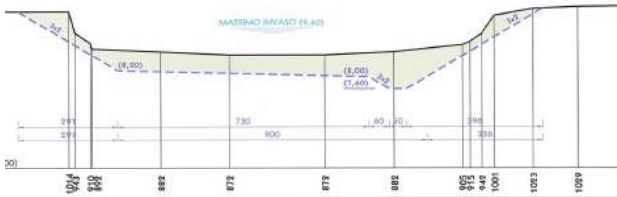
Planimetria e sezione irriguo Stretti Sud da convertire a scolo con risezionamento
