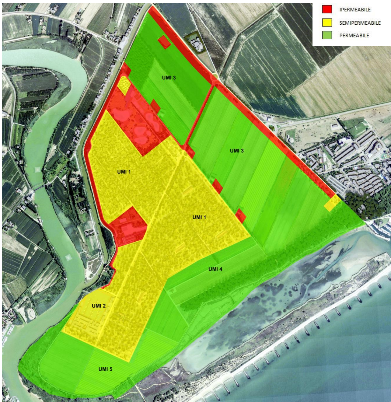
Figura 7-2: Impermeabilizzazione prevista dalla proposta PUA
