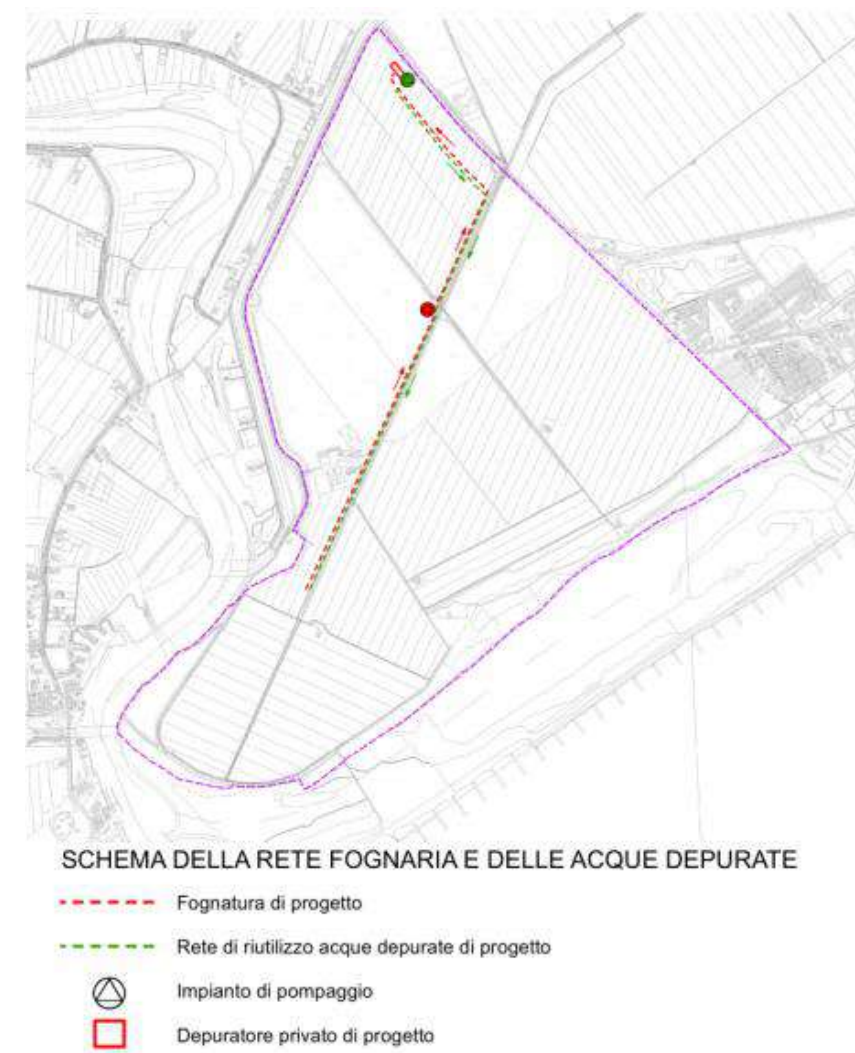
Figura 4-31: Schema rete fognatura e depurazione di Valle Ossi
