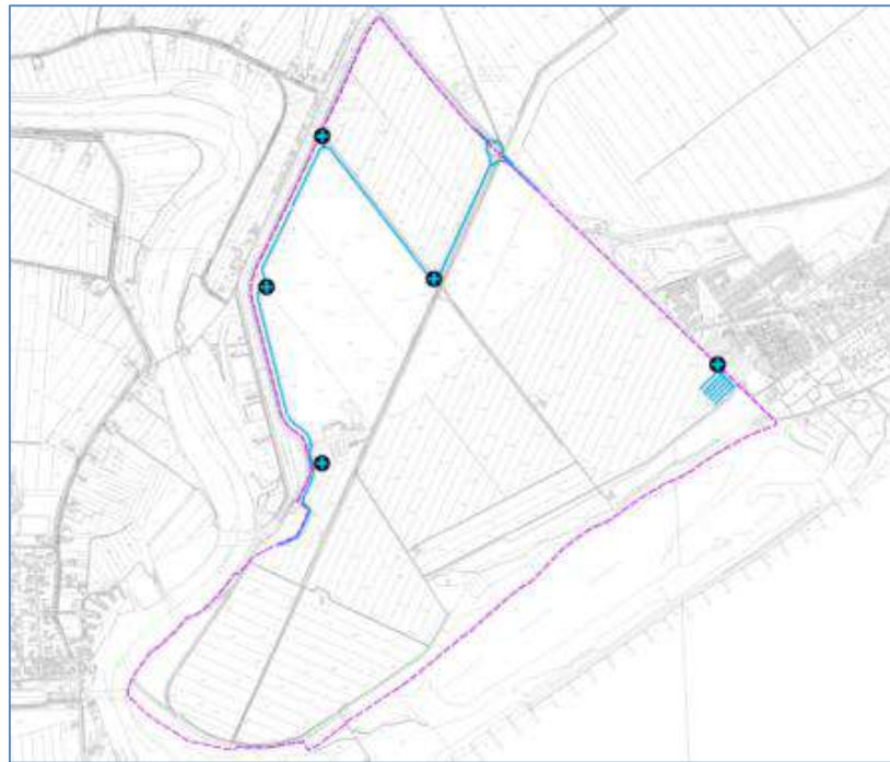
Figura 5-108: Sistema di raccolta acque di dilavamento superfici pubbliche adibite a strade e parcheggi.
